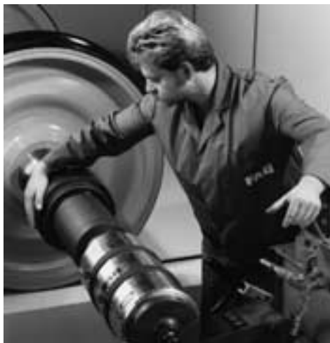
Montagem hidráulica a pressão de uma unidade de rolamento de rodas TAROL sobre a ponta do eixo
