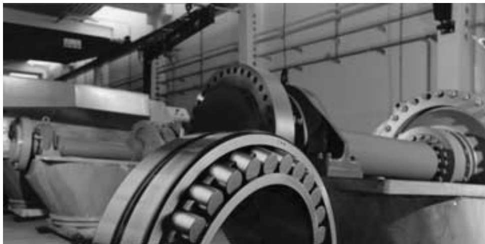
Rolamentos autocompensadores de rolos em mancais de rotores
